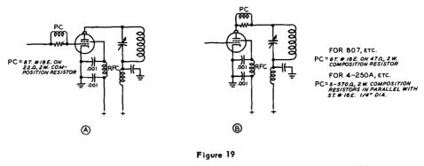
PLATE AND GRID PARASITIC SUPPRESSION IN TETRODE TUBES
