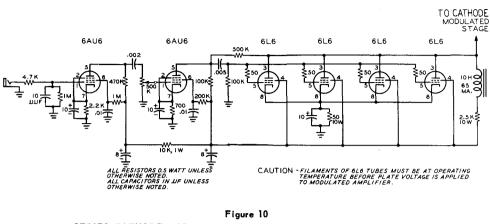
SERIES CATHODE MODULATOR FOR A HIGH-POWERED TRIODE R-F
