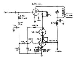
Figure 14 SINGLE-STAGE SCREEN GRID KEYER FOR TETRODE TUBES
