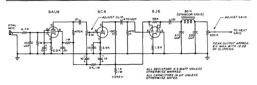
Figure 19 CLIPPER FILTER USING 6J6 DOUBLE TRIODE STAGE
