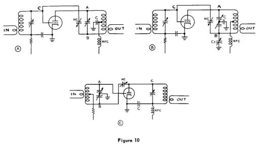
COMMON NEUTRALIZING CIRCUITS FOR SINGLE-ENDED AMPLIFIERS
