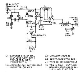
Figure 44 SCHEMATIC, SINGLE-WIRE ANTENNA TUNER
