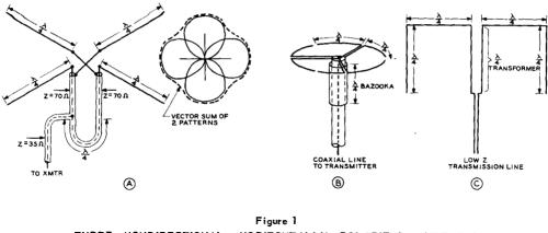
THREE NONDIRECTIONAL, HORIZONTALLY POLARIZED ANTENNAS
