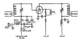
Figure 11 SIMPLE BLOCKED-GRID KEYING SYSTEM
