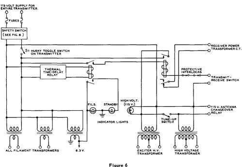
TRANSMITTER CONTROL CIRCUIT
