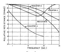
Figure 3 FREQUENCY EFFECTS ON SAMPLE COMPOSITION RESISTORS
