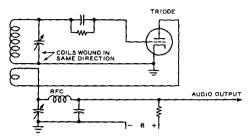
PLATE-TICKLER REGENERATION WITH "THROTTLE" CONDENSER REGENERATION CONTROL.
