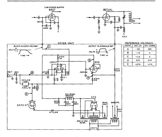
Figure 16 TWO-STAGE SCREEN GRID KEYER UNIT
