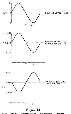
POLARITY REVERSAL BETWEEN GRID AND PLATE VOLTAGES
