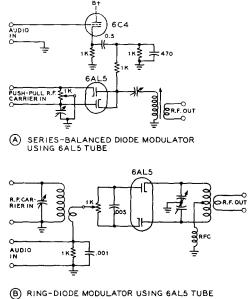
Figure 13 VACUUM DIODE MODULATOR CIRCUITS
