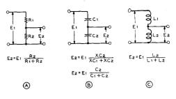
Figure 16 SIMPLE A-C VOLTAGE DIVIDERS
