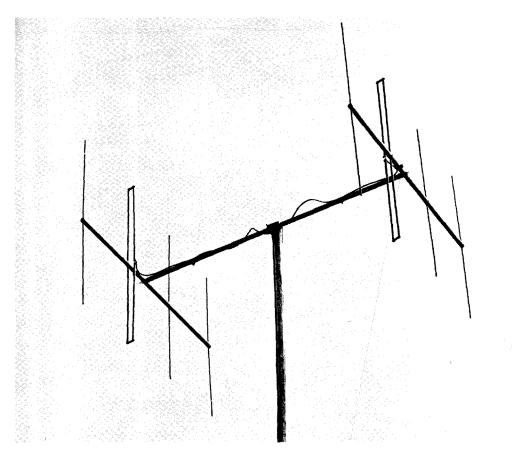
Figure 14 THE EIGHT-ELEMENT 144-MC. ARRAY IN A HORIZONTAL POSITION
