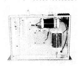
Figure 13 UNDERSIDE OF THE GROUNDED-GRID AMPLIFIER
