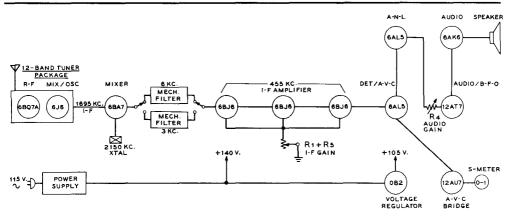
Figure 17 BLOCK DIAGRAM OF DE-LUXE AMATEUR COMMUNICATION RECEIVER
