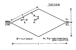
Figure 11 V-H-F RHOMBIC ANTENNA CONSTRUCTION
