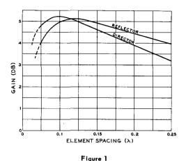
GAIN VS ELEMENT SPACING FOR A TWO-ELEMENT CLOSE-SPACED PARASITIC BEAM ANTENNA WITH PARASITIC ELE-MENT OPERATING AS A DIRECTOR OR REFLECTOR
