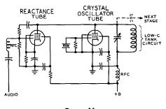
Figure 11 REACTANCE-TUBE MODULATION OF CRYSTAL OSCILLATOR STAGE
