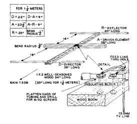
Figure 12 SIMPLE 3-ELEMENT BEAM FOR 2 AND 11/2 METERS
