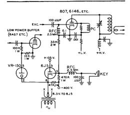
Figure 13 TWO-STAGE BLOCKED-GRID KEYER
