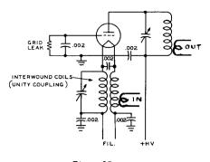
Figure 15 GROUNDED-GRID AMPLIFIER
