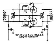
Figure 16 GRID PARASITIC SUPPRESSORS IN PUSH-PULL TRIODE STAGE
