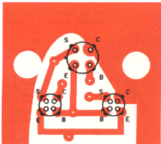
Fig. 5 - Montaggio degli zoccoli portatransistori sulla relativa bassetta.
