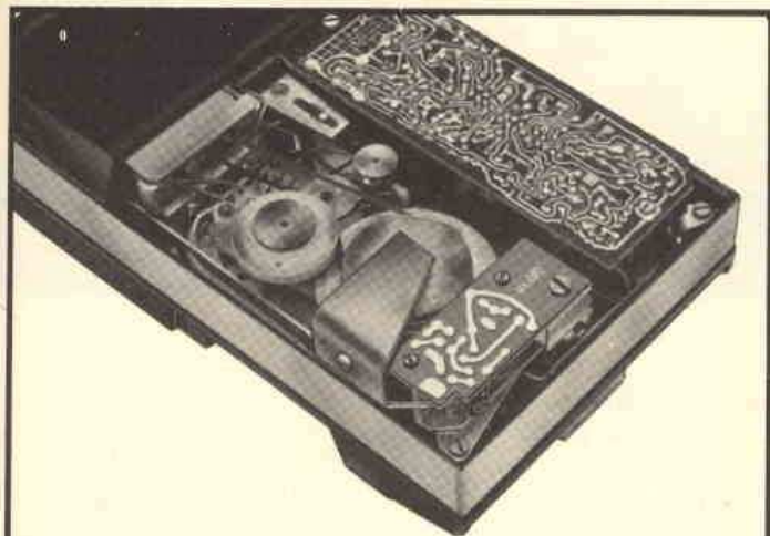
Fig. 5 - Esempio di montaggio dell'UK 690 all'interno del registratore a cassetta Philips EL3302.
