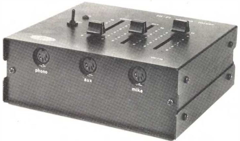
Vista frontale dell'UK 716 dell'Amtron a realizzazione ultimata, si notino le prese d'ingresso.
