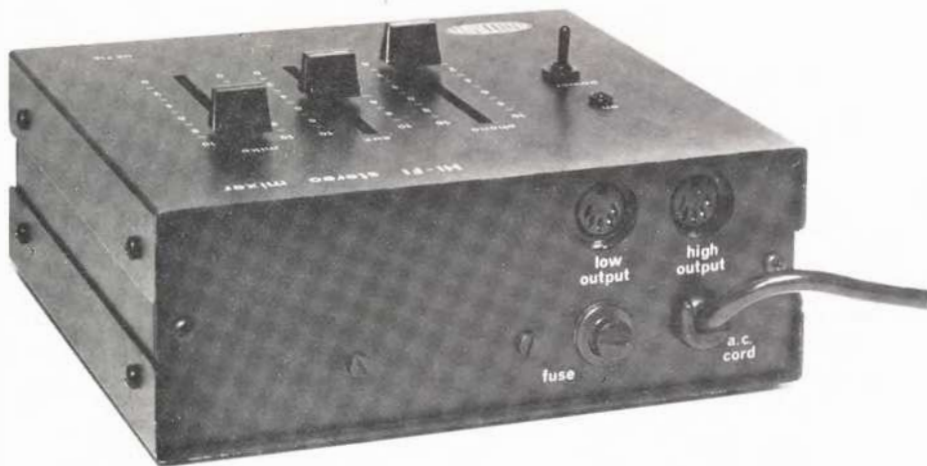
Vista posteriore dell'UK 716 dell'Amtron a realizzazione ultimata. In primo piano le prese di uscita
