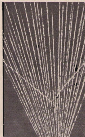
Fig. 3. Fotografia in Camera di Wilson: bombardamento, con raggi « alfa », di gas elio.
