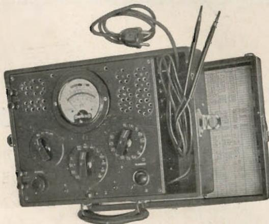
Pannello in bachelite stampata - Diciture in rilievo ed incise - Commutatori a scatto con posizione di riposo - Prova tutte le valvole comprese le Octal - Misura tensioni in corr. cont. ed alt. da 100 Millivolt a 1000 Volt. intensità; resist. da 1 ohm a 5 Megaohm - Misura tutte le capacità fra 50 cm. a 14 m.F. - Serve quale misuratore di uscita - Prova isolamento - Continuità di circuiti - Garanzia mesi 6 - Precisione - Semplicità di manovra e d'uso - Robustezza.
