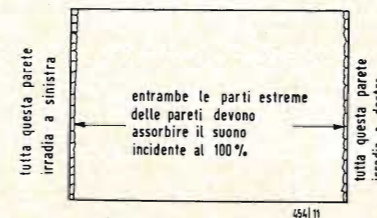
Fig. 1 - Modo ipotetico di ottenere un effetto stereofonico a mezzo d'onde * plane irradianti dalle pareti opposte del locale.
