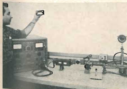
La MICRO ELECTRONICS CORP. ha sviluppato un compatto amplificatore con diodo tunnel all'antimoniuro di gallio per le bande UHF e L. La fotografia mostra un tecnico che presenta l'amplificatore sul quale si è misurato un fattore di rumore di soli 2,5 dB. Numerose sono le applicazioni di questo amplificatore: radar, telemetria, teoposcatte, bracing di missili, ricevitori TV e commerciali, ecc.
