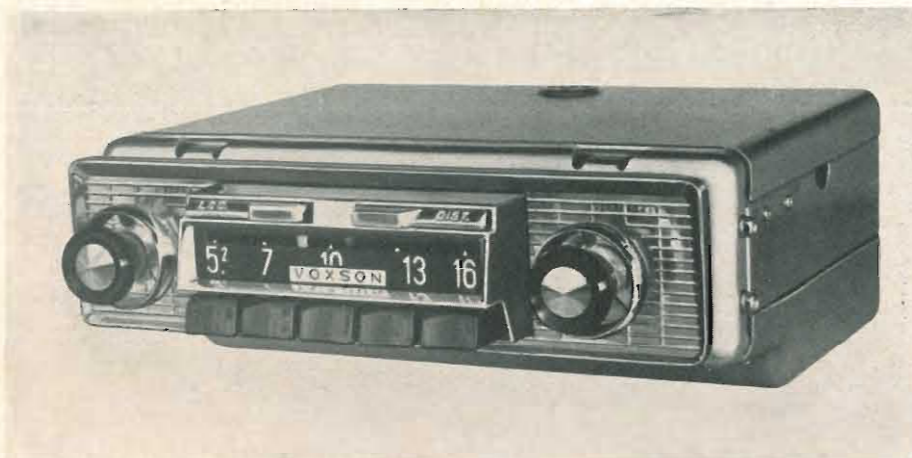
Fig. 1 - Ecco come si presenta il nuovo Voxson «Explorer», l'apparecchio che funziona esclusivamente a transistori ed ha non solamente la sintonia a pulsanti ma anche la ricerca elettronica delle stazioni. Si noti la struttura compatta dell'apparecchio e la razionale disposizione dei comandi. La custodia metallica non presenta alcun foro di aerazione, perché i circuiti a transistori contenuti nell'interno non producono calore; soltanto il transistor finale, sistemato dietro l'apparecchio, è munito di apposito radiatore alettato non visibile nella fotografia.
