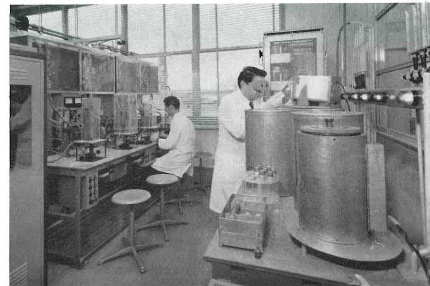
Reparto Tubi ad onde progressive. Le tecniche di brasatura vetro-metallo e ceramica-metallo per tenute ad alto vuoto (di cui si scorgono alcune apparecchiature) hanno compiuto notevoli avanzamenti a seguito della ricerca applicata svolta dai tecnici del reparto.
