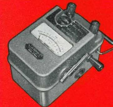
Fig. 4 - Misuratore di isolamento
