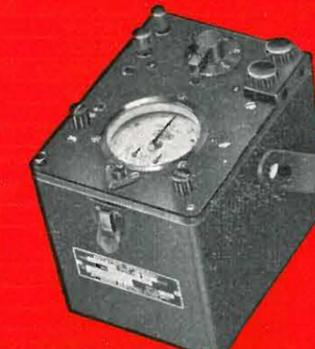
Fig. 6 - Contatore campione
