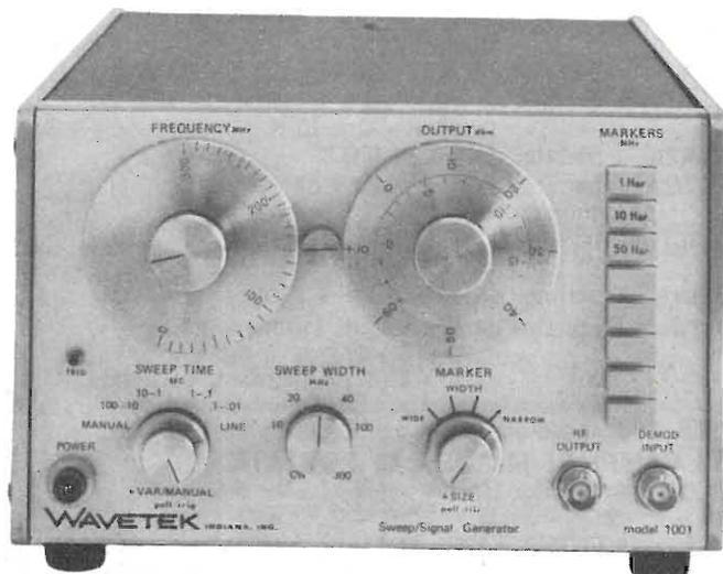
POTETE coprire la gamma da 0,1 MHz a 1000 MHz (VHF-UHF) scegliendo tra molti modelli per soddisfare le diverse esigenze di produzione o di laboratorio. In figura è mostrato il Mod. 1001, ideale per il laboratorio, che copre la gamma da 0,5 MHz a 300 MHz in uno sweep, uscita + 13 dbm sull'intera gamma con 0,25 db di piattezza, programmabile in frequenza, ampiezza sweep ed attenuazione (20 db), usabile come generatore di segnali con attenuatore calibrato d'uscita.
