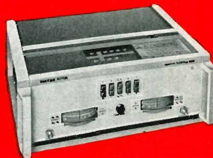
Fig. 6 - Ponte universale Tipo B 602 per misure di C, R, L, G a radio frequenze (100 KHz - 10 MHz)
