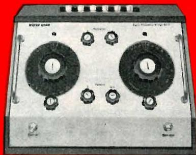
Fig. 4 - Ponte Tipo B 601 per misure di R, C, L a radiofrequenze (15 KHz - 5 MHz)
