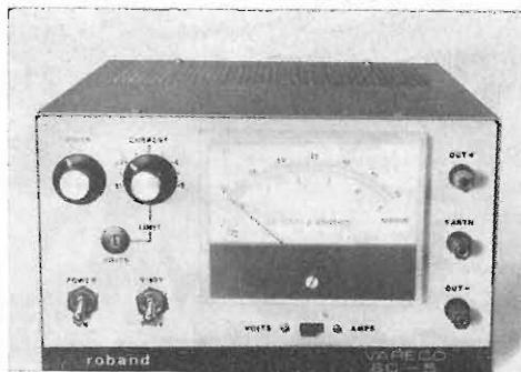
La protezione contro la sovratensione variabile è facile da impostare ad un livello subito sopra la tensione d'esercizio e impedisce danni accidentali in circuiti a carico critico.
