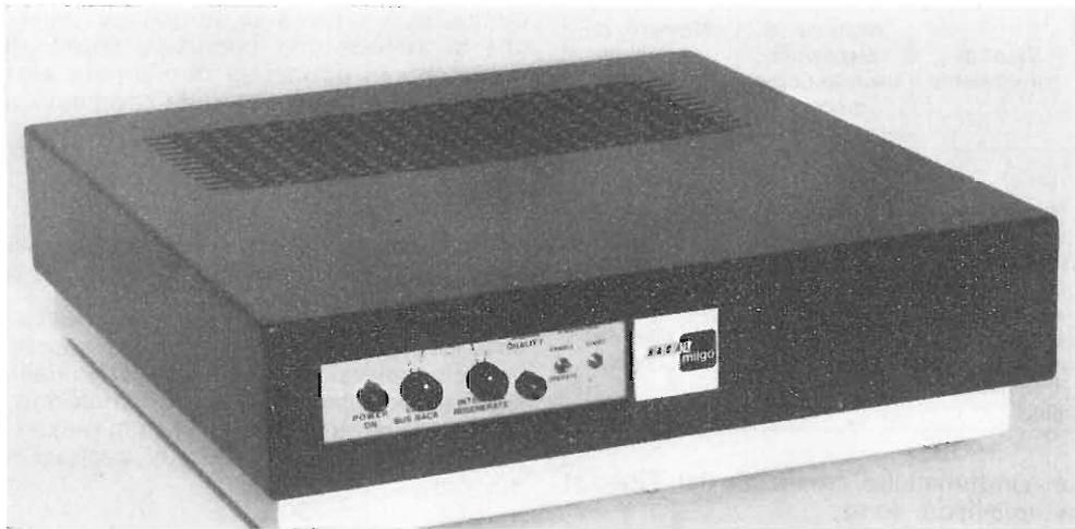
**Modem di dati capace di trasmettere e ricevere 4800 bit al secondo**
