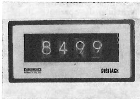
**Dati speciali:** Gamma di frequenze 0 ... 1 MHz. Sensibilità 100 mV<sub>eff</sub>. Resistenza di entrata:  $\geq 20$  k Ohm. Base del tempo, frequenza della rete 50 Hz. Errore ca. 0,1%. Tempo di misura 0,1/0,6/1 s.
