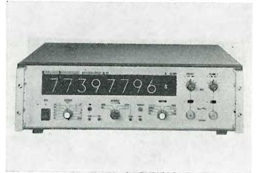
frequenze normali. Sensibilità 100 mV<sub>eff</sub> da 0 ... 10 MHz, 1 V<sub>pp</sub> con 50 MHz, limitazione da 2 V<sub>pp</sub>. Impedenza 12 k Ohm il 30 pF. Livello del sincro ± 1 V regolabile con continuità. Impiego del trigger a scelta con segnale in salita o in discesa.
