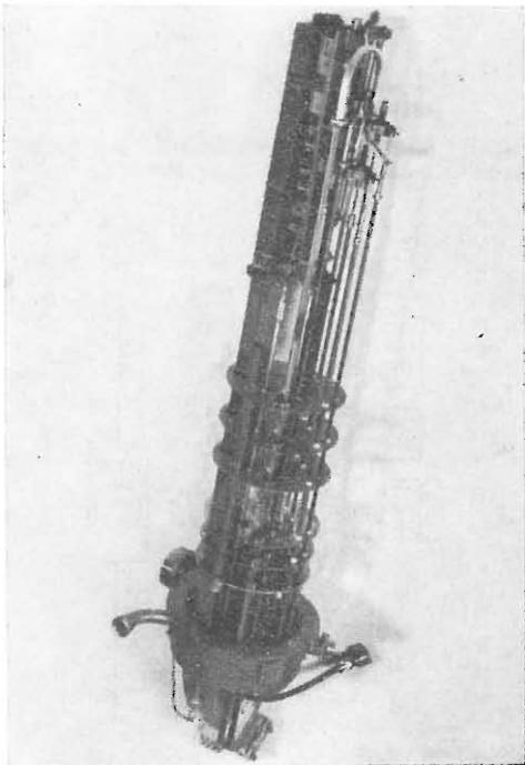
dimostra che il R.O.S. è minore di 1,3, salvo negli ultimi 20 MHz della banda. Lo stesso complesso di componenti è stato accoppiato ad un frigorifero meccanico, che raffredda i componenti a  $20^\circ K$ . La prestazione guadagno-frequenza è la stessa con questa apparecchiatura, mentre la temperatura di rumore aumenta a  $25^\circ K$  agli estremi della banda, ma diminuisce a  $20^\circ K$  al centro banda.
