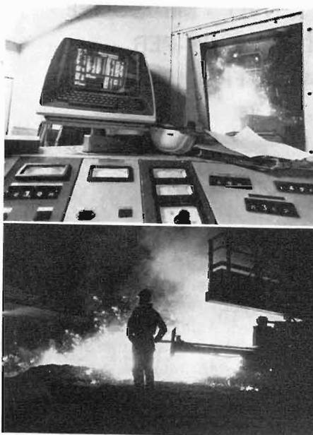
Il controllo computerizzato delle operazioni presso le acciaierie olandesi Hoogovens consente di controllare rapidamente il progresso di ogni singola ordinazione, assicurando la corretta distribuzione dei materiali in tutta l'acciaieria.
