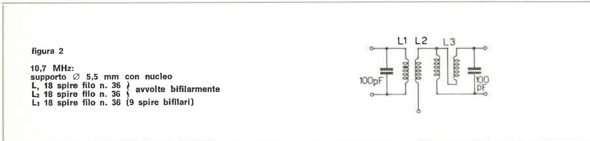
L'avvolgimento bifilare serve per ottenere un accoppiamento stretto tra L<sub>1</sub> e L<sub>2</sub>, e una buona presa centrale in L<sub>3</sub>; si deve poi realizzare quell'accoppiamento magnetico fra i due supporti (uno per L<sub>1</sub> e L<sub>2</sub>, e l'altro per L<sub>3</sub>) che dà la migliore linearità, cosa che si realizza assai facilmente eseguendo la taratura con sweep e oscilloscopio.
