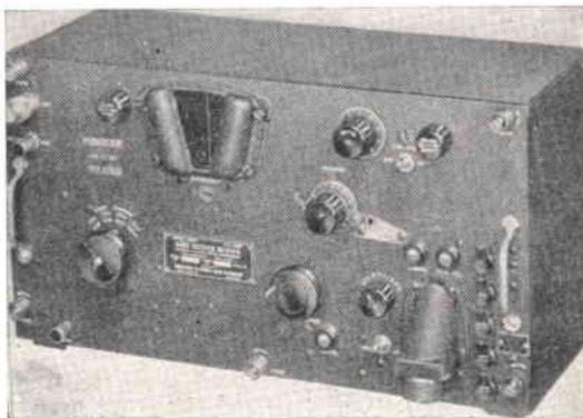
Ricevitori BC-312/AC - Come sopra con alimentatore funzionante in corrente alternata da 110-125-140-160-220 V, internamente incorporato. Viene venduto al prezzo di L. 35.000 funzionante e provato prima di essere spedito.
