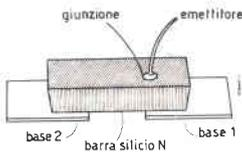
Attualmente questo tipo di costruzione si ritiene superato e i transistor unigiunzione vengono anch'essi costruiti con le tecniche più perfezionate.
