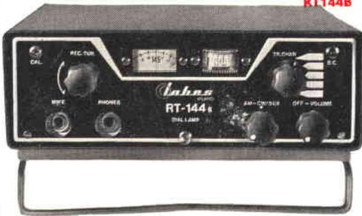
Ricetrasmittitore portatile per i 2 mt.
