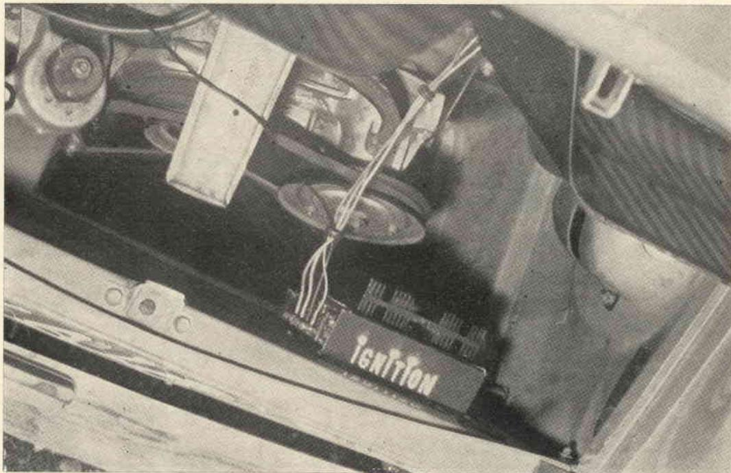
I fili di collegamento **debbono avere una sezione superiore a 1,5 mm<sup>2</sup>** e il rivestimento è preferibile termoisolante. Il montaggio meccanico deve essere il più solido possibile (le sollecitazioni sono notevoli) e non presenta criticità se non nella scelta del punto dove applicare l'accensione che **deve** essere lontana dai punti più caldi del motore (collettori di scarico) e posto in un luogo ventilato e riparato dagli spruzzi dell'acqua.
