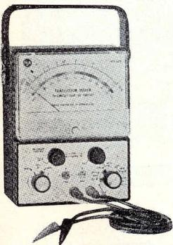
Il **Tester** mod. **WT-501A** da la possibilità di misurare i più importanti parametri dei transistori sia NPN che PNP senza che sia neppure necessario isolare questi dal circuito in cui sono montati. Questo piccolo apparecchio alimentato a batteria può essere usato oltre che in laboratorio anche in produzione, con l'aggiunta di adeguati adattatori (come ad esempio quelli Tektronix).
