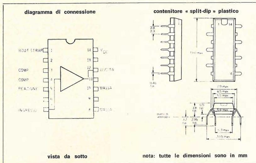
La bassa resistenza termica è data da una barretta di rame inserita e affogata nella plastica, che permette di ottenere una bassa resistenza termica.
