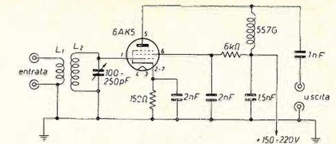
Per i possessori del noto ricevitore BC348 consiglio di provare ad accoppiarlo con un apparecchio anche casalingo per onde medie al fine di ottenere la ricezione in doppia conversione. Chi ha sperimentato quanto detto assicura un incremento delle prestazioni del già buono suddetto ricevitore surplus.
