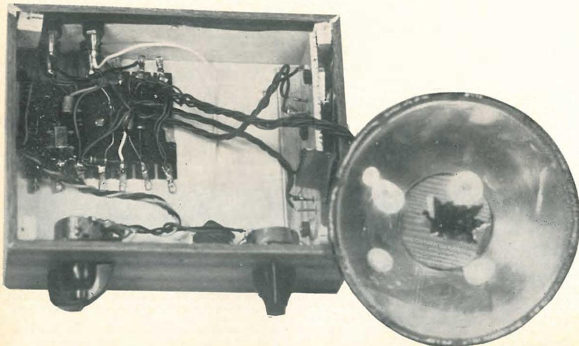
La massa del circuito può essere indifferentemente il + o il - a seconda dell'impianto della vostra macchina.
