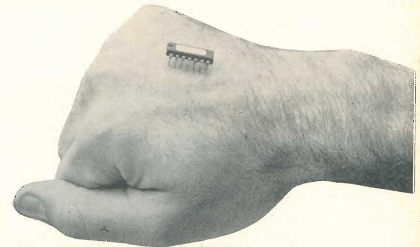
Il TAA611/B è un circuito integrato monolitico particolarmente adatto come amplificatore audio in radioricevitori, giradischi e apparecchi TV portatili, nonché utilizzabile come modulatore di piccoli trasmettitori a transistor fino a due watt di potenza.
