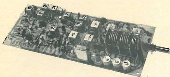
Ricevitore per la banda 28-30 Mc/s (a richiesta 26-28 Mc/s o 26,8-27,4 Mc/s) progettato per l'uso in unione con convertitori 144-146 Mc/s. Impiega 3 Mosfet autoprotetti, 2 Fet, 6 transistori al silicio, 5 diodi, 1 zener.
