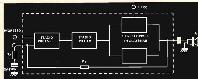
Come noterete dallo schema a blocchi, la piastrina di silicio monolitico contiene uno stadio preamplificatore, uno stadio pilota e uno stadio finale in classe AB a simmetria complementare. L'accoppiamento all'altoparlante viene effettuato capacitivamente. La resistenza esterna  $R_A$  permette di variare la controreazione dell'amplificatore e quindi adatta il TAA611/B a tutte le esigenze in dipendenza del segnale in ingresso.
