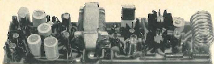
Potenza uscita su carico di 52 ohm 1 Watt. Modulazione di collettore di alta qualità con pre-modulazione dello stadio driver. Profondità di modulazione 100%. Ingresso modulatore: adatto per microfono ad alta impedenza. Oscillatore pilota controllato a quarzo. Gamma di funzionamento 26-30 MHz. Materiali professionali: circuito stampato in fibra di vetro. Dimensioni: mm. 157 x 44. Alimentazione: 12 Volt C.C. Adatto per radiotelefoni, radiocomandi, applicazioni sperimentali.
