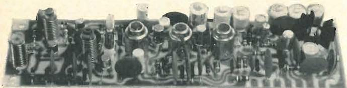
1 microvolt per 15 dB di rapporto segnale disturbo. Selettività  $\pm 9$  KHz a 22 dB. Oscillatore di conversione controllato a quarzo. Gamma di funzionamento 26-30 MHz. Circuito silenziatore a soglia regolabile, sensibilità 1 microvolt. Amplificatore BF a circuito integrato al silicio potenza 1 Watt. Alimentazione 9 Volt 20 mA. Dimensioni mm. 157 x 44.
