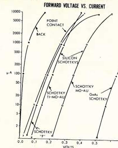
La figura 5 confronta la caduta di tensione diretta di vari tipi di diodi: si noti come la caratteristica raddrizzante di un diodo Schottky sia molto prossima e quella di un diodo a punta di contatto: si intuisce come possa perciò sostituirlo. Applicazioni: questi diodi stanno diffondendosi particolarmente come miscelatori in microonde.
