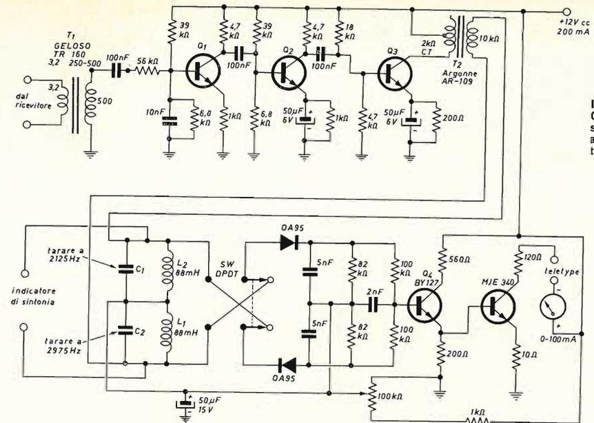
I transistori Q<sub>1</sub> - Q<sub>2</sub> - Q<sub>3</sub> - Q<sub>4</sub> sono dei Texas al silicio tipo TI492
