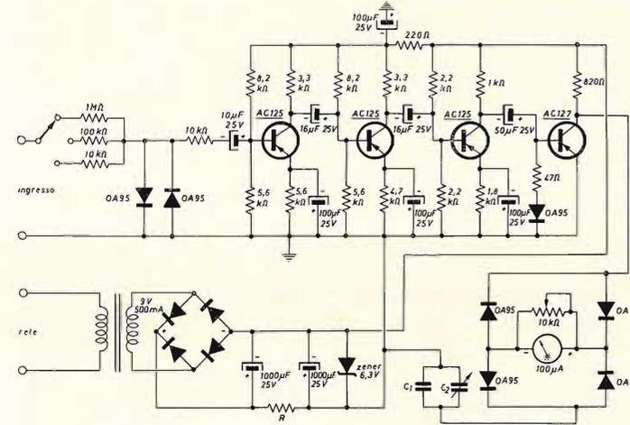
Variando la frequenza del generatore tracciare sul quadrante dello strumento una scala con l'indicazione delle frequenze che ci interessano, e in particolare evidenza i 2125 e 2975 Hz.
