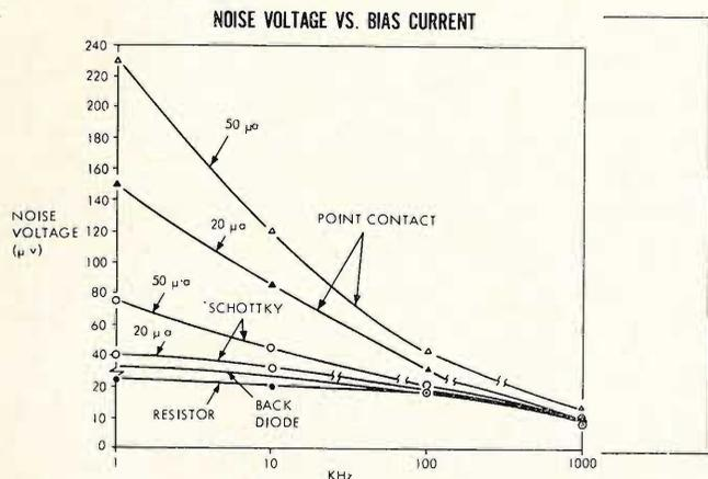
La figura 4 confronta il rumore espresso in tensione di vari tipi di diodi per diverse correnti di polarizzazione.
