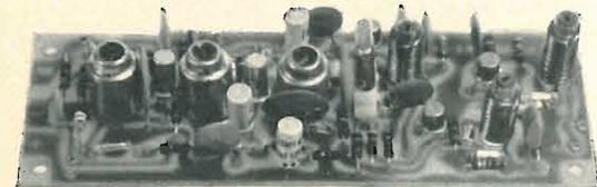
1 microvolt per 15 dB di rapporto segnale disturbo. Selettività:  $\pm 9$  MHz a 22 dB. Oscillatore di conversione controllato a quarzo. Media frequenza a 455 KHz. Gamma di funzionamento 26-30 MHz. Materiale professionale: circuito stampato in fibra di vetro. Dimensioni: mm. 120 x 42. Alimentazione: 9 V 8 mA. Adatto per radiocomandi, radiotelefoni, applicazioni sperimentali.
