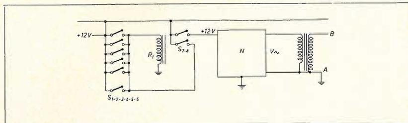
Applichiamo un relay a 2 scambi che si ecciti chiudendo uno qualsiasi degli interruttori  $S_{1-2-3-4-5-6}$  (che sono poi dei contatti applicati alle portiere, al cofano motore e portabagagli). Il relay stesso rimane eccitato tramite  $S_7$ , che è uno scambio del relay stesso.  $S_8$  è l'altro scambio del relay e alimenta l'invertitore N (quello descritto a pagina 532 maggio 1970 di cq elettronica).
