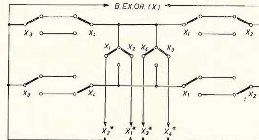
Questo ultimo schema è effettivamente realizzabile in quanto per il suo funzionamento sono sufficienti 4 commutatori a 8 vie e 6 posizioni (!) regolarmente in commercio.
