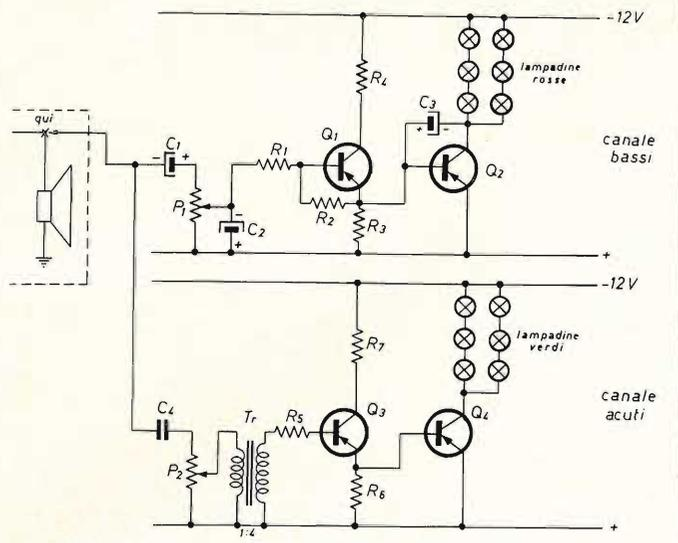
Naturalmente bisogna badare a non alzare eccessivamente il volume della radio, perché oltre a non ottenere più il gioco di luci, si rischia di bruciare le lampadine in quanto i transistor finali saturerebbero portando tutti i 12 V ai capi di queste.
