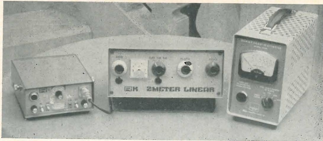
Il lineare pilotato da un piccolo transceiver e controllo di potenza con wattmetro RF.
