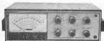
**Millivoltmetro transistorizzato IM 16**
