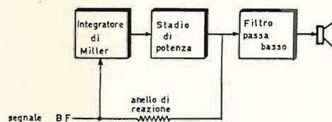
Fig. 6 - Stenogramma di amplificatore in classe "D" ad anello chiuso
