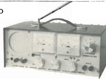
Voltmetro ed amperometro incorporati. L'alimentatore comprende anche un generatore di disturbi simile ai disturbi generati dalle candele dell'automobile, un altoparlante 4  $\Omega$  6 W, una antenna con relativo compensatore. Questo apparecchio è stato progettato per il servizio di assistenza e comprende tutti quegli accessori per il collaudo sul banco di un'autoradio.
