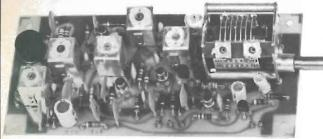
Gamma di frequenza 26-28 MHz, stabilità migliore di 100 Hz/h, uscita 75 ohm, alimentazione 12-16 V, adatto a pilotare trasmettitori che usano quarzi da 26...28 MHz, oppure da usarsi per la costruzione di trasmettitori a conversione per la gamma 144-146 MHz, dim. 13 x 6.
