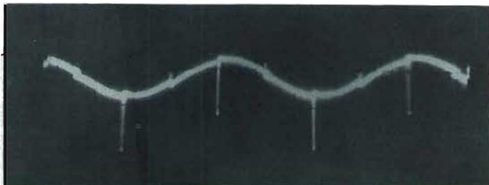
9) Idem come sopra, con ampiezza relativa a  $0,1 V / cm$ , presa per evidenziare la fase corretta del segnale sinusoidale di sincronismo che supporta il segnale multiplexato (le quattro piccole tracce verticali devono apparire al centro dei picchi della sinusoide, sia negativi che positivi).
