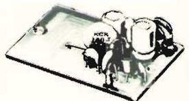
Utilissimo in tutti i casi ove necessita la trasformazione di un segnale video composito in un segnale ad alta frequenza da applicare alla presa di antenna di un normale televisore in bianco e nero oppure a colori.
