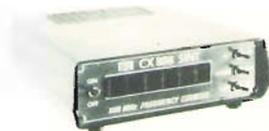
Ottimo per VHF/UHF applicato al VFO presenta in display la esatta frequenza di trasmissione/ricezione.
