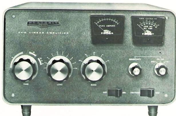
La coppia di valvole Eimac 3-500Z eroga 2000 watt PEP in fonìa e fino a 1000 watt in CW e RTTY. Ha un doppio strumento sul pannello frontale per rendere più facile il funzionamento e la sintonizzazione; un ingresso a «pi greco», pre-sintonizzato a larga banda per la massima efficienza con bassa distorsione nelle bande da 80 a 15 metri.
