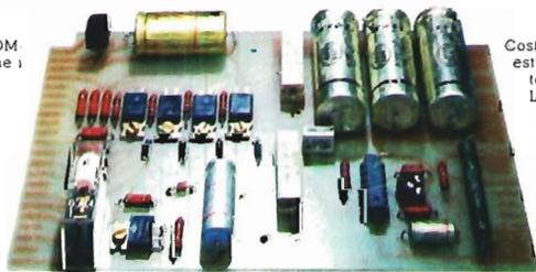
Costruzione completamente modulare su «CARDS» estraibili dai vari circuiti per facili controlli e manutenzione.
