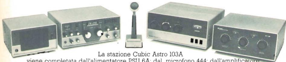
La stazione Cubic Astro 103A viene completata dall'alimentatore PSU 6A; dal microfono 444; dall'amplificatore lineare 1500ZA con output di 750 W PEP nominali; dall'accordatore di antenna ST-2B.
