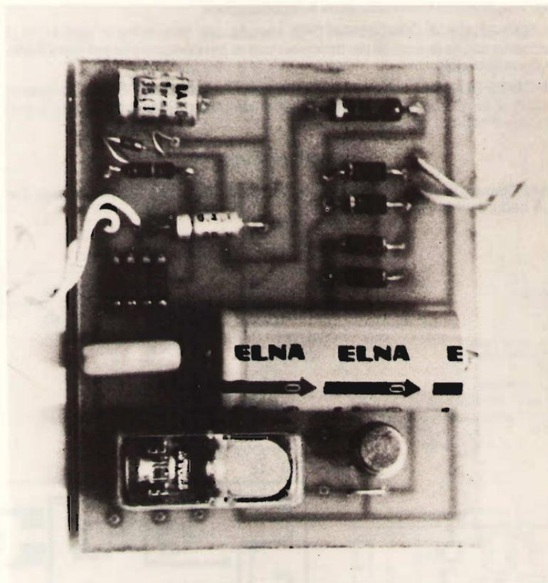
Diamo tensione al circuito e analizziamo le tensioni presenti nei vari punti. L'ingresso negativo del comparatore superiore è mantenuto dal partitore interno a  $2/3$  della  $V_{cc}$ , come l'ingresso positivo del comparatore inferiore è mantenuto a  $1/3$  della  $V_{cc}$ .
