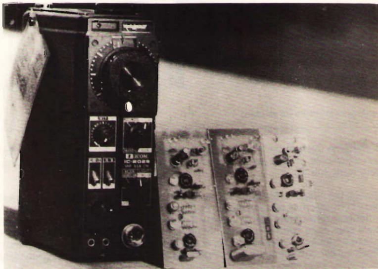
Lo schema elettrico è composto da un oscillatore quarzato a fet, questi è fatto funzionare direttamente in armonica 3<sup>a</sup>, 4<sup>a</sup>, 5<sup>a</sup> overtone, un eventuale calcolo di esempio è riportato in tabella 1; indi segue un filtro elicoidale in aria dalle bobine rispettivamente L<sub>1</sub>, L<sub>2</sub> che consentono di far passare l'armonica richiesta adeguatamente filtrata e subito amplificata dal secondo stadio a fet con gate comune.
