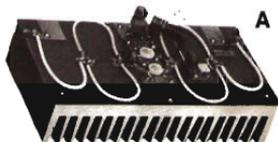
• **AMPLIFICATORE A LARGA BANDA** (88 + 104 MHz). Potenza di uscita 250W (310 W max). Potenza di ingresso 20 Wmin. 36W max. Alimentazione 24 + 28 Vcc. Rendimento > 70% 14 + 18A. Può essere pilotato da un TL 33 oppure da un TL 100 dando oltre 1 KW con quattro moduli.
