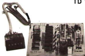
• **ECCITATORE PROGRAMMABILE** con commutatore digitale. Banda coperta 88 - 104 MHz. Uscita 200 mW regolabili. Spuria -70 dB. Alimentazione 12,5 Vcc. Ingressi mono-stereo. Modulazione FM - 75 KHz regolabili. Adatto a pilotare un modulo TL33 da 20W out a larga banda.
