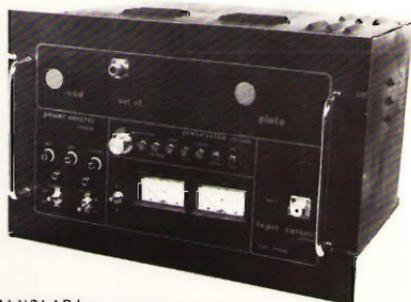
Dati tecnici: programmazione a mezzo di 4 contravers binari; -frequenza out 87-108 oppure 52-68Mhz;-potenza out regolabile; -entrata stereo e mono con preenfasi; -attenuazione prodotti spuri e armoniche a norme;-distorsione in b.f. <dello 0,3%;- diodo led di aggancio;-
