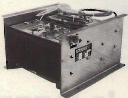
I ns. moduli di potenza estremamente robusti ed affidabili, amplificano segnali in gamma 88-104 MHz senza necessità di alcun accordo o taratura. Sono ovviamente componibili per ottenere maggiori potenze d'uscita: 800, 1600 W e potendo assumere varie configurazioni si può ottenere il livello di eccitazione all'ingresso desiderato: 10, 40, 200 W per il sistema da 800 W oppure 20, 80, 400 W per quello da 1600 W.
