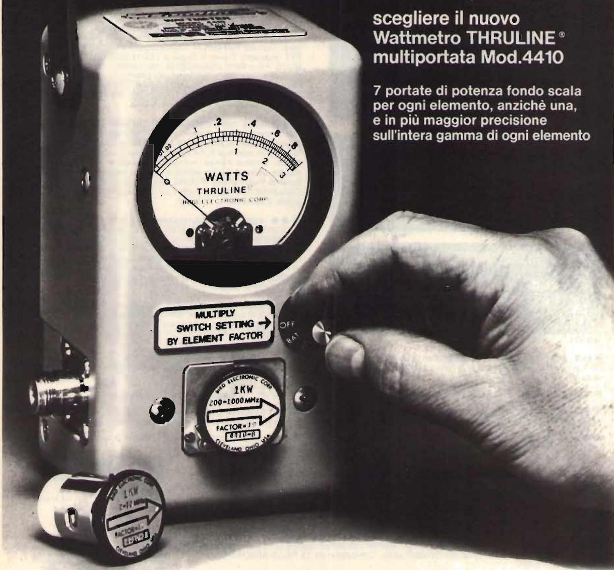
**MODELLO 4410: UN NUOVO WATTMETRO RF BIDIREZIONALE PORTATILE MULTIPORTATA** 1/3/10/30/100/300/1.000 Watt oppure 10/30/100/1.000/3.000/10.000 Watt per ogni elemento nel campo di frequenze da 0,2 a 1000 MHz per segnali CW oppure FM. Precisione  $\pm 5\%$  DELLA LETTURA da 200 milliwatt in su (2-1000 MHz) su gamma di temperatura compensata da 0°C a 50°C.
