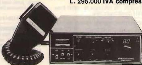
Ricetrasmittitore 120 canali (80 + 40) divisi in 3 bande con display digitale.
