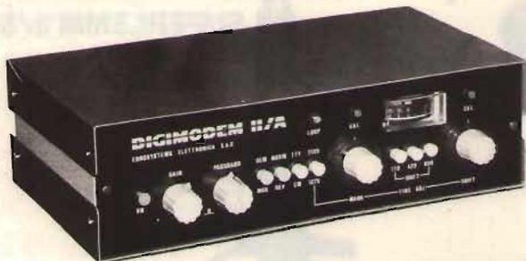
Stesse caratteristiche del DIGIMODEM I/A ma senza indicatore R.C. e frequenzimetro; è dotato di indicatore di sintonia a led e a VU-METER. È predisposto per essere collegato ad un oscilloscopio esterno per la sintonia ad ellissi.
