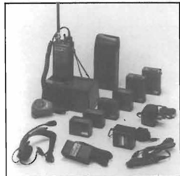
impostate dai 16 tasti frontali; il CPU permette la ricerca fra le 10 memorie, il canale prioritario, o la ricerca entro limiti di banda opportunamente impostati con incrementi di 12.5 o 25 KHz; lo scostamento in frequenza normalizzato o programmabile per l'accesso ai ripetitori, ecc. Il visore indica il livello del segnale ricevuto "S Meter", la potenza relativa in uscita dal Tx nonché funzioni varie.
