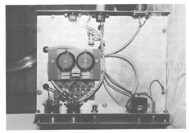
Vista del cablaggio e del filtro BF.
