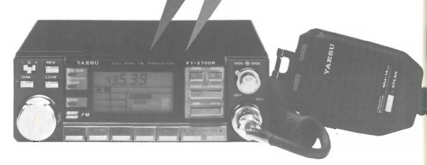
Praticamente due ricetrasmettitori in uno, questo è l'ultimo nato in casa YAESU. Il primo Dualbander con 25 Watt di output in un unico chassis. La presenza di un microprocessore provvede alla gestione di 10 memorie, doppio VFO e due frequenze con Backup di batterie al litio. Il sistema YAESU PMS permette inoltre lo scanning tra le memorie. Quattro differenti possibilità operative: RX-TX in VHF; RX-TX in UHF; RX in VHF e TX in UHF; RX in UHF e TX in VHF.
