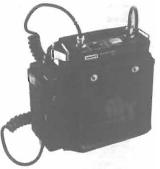
Il ricetrasmettitore nella sua configurazione completa assomiglia alle realizzazioni tradizionali: sezione RF superiore, dalle dimensioni paragonabili ad un normale microfono, e la parte inferiore ad incastro contenente le batterie
