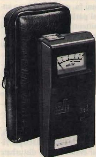
Piccolo, pratico contatore Geiger tascabile per il controllo di elementi radioattivi sospetti e cioè i noti raggi alfa, beta, gamma ed altri isòtopi non così conosciuti. Esso ha una precisione sufficiente per avvertire che esistono bassi livelli di radiazione, anche a livello innocuo, e può avvertire quando essi superano la soglia di allarme.
