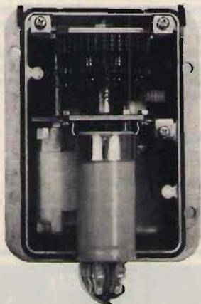
L'unità di controllo dispone della pre-impostazione ("Preset" sul modello PE) nonché di una proiezione gnomonica sull'indicatore azimutale. Alimentazione a 24V con cavo a 6 poli. Rotazione completa in 70 secondi. Eccovi perciò il rotatore che non occorrerà più smontare: per una eventuale riparazione basterà sostituire il modulo-motore interessato. Concetto semplicissimo, però nessuno vi aveva ancora pensato!
