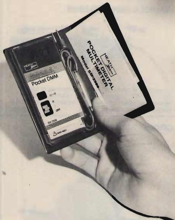
A doppia integrazione, con display a cristalli liquidi (massima lettura 1999), cambio automatico di portata e di polarità. Misure di tensione continua ed alternata (fino a 1999 mV e 400 V), della resistenza (fino a 200  $\Omega$  e 1999 k $\Omega$ ).
