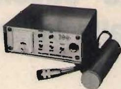
**AP-HF:** preselettore, attenuatore, preamplificatore d'antenna da 1,5 a 30 MHz in 4 segmenti, da accoppiare a ricetrans o ricevitori. Guadagno oltre 18 dB. Escludibile senza staccarlo dal cavo di antenna. Passibilità di QSK in CW. Potenza in transisto 2000W max. È il moltiplicatore di QSO.
