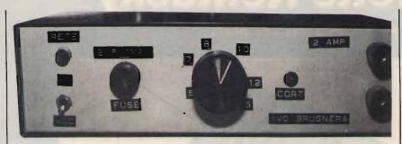
foto 2 Alimentatore variabile a transistor.
