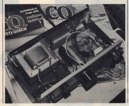
gio. Il trasformatore è da 220→18 V, 3 A, la tensione del secondario non è critica: 15÷20 V vanno ugualmente bene, la corrente max di questo alimentatore è di circa 2,5 A, buona per tutti gli usi di laboratorio o per baracchini CB.
