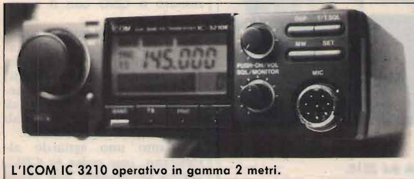
L'ICOM IC 3210 operativo in gamma 2 metri.
