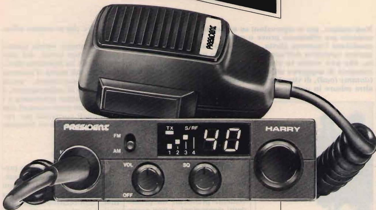
Apparato ricetrasmittente veicolare, di dimensioni molto contenute, adatto per chi ha problemi di spazio nell'installazione su automezzi. Molto simile al PRO-510e, può trasmettere anche in modulazione di frequenza. È dotato di indicatore di canale a display, di selettore di canali, di controllo di squelch e di volume, di staffa per il montaggio veicolare e di 4 led per indicare l'intensità del segnale.
