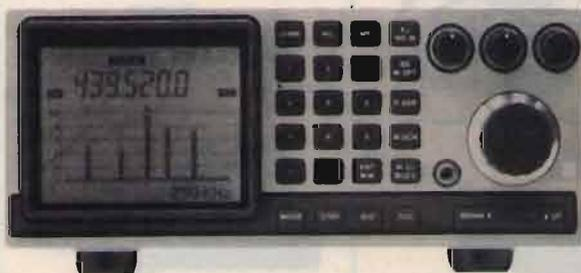
Analizzatore di spettro incorporato!
