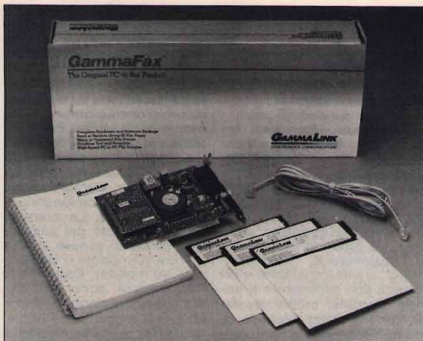
Una scheda fax e il software apposito consentono di usare il calcolatore come apparecchio per comunicazioni via facsimile.
