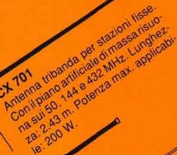
Antenna tribanda per stazioni fisse. Con il piano artificiale di massa risuona sui 50, 144 e 432 MHz. Lunghezza: 2,43 m. Potenza max. applicabile: 200 W.
