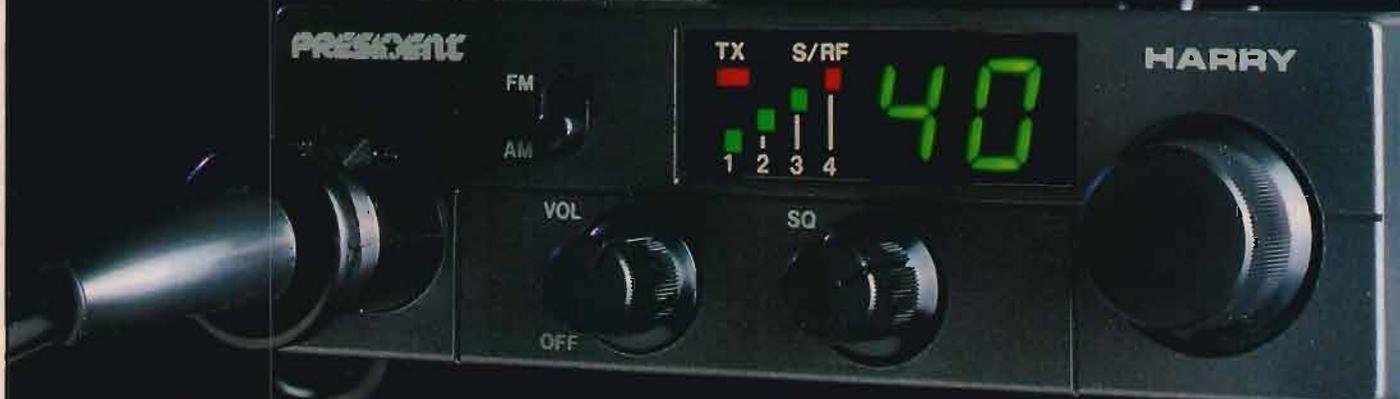
**Ricetrasmittitore CB 27 MHz AM/FM 40 ch**
