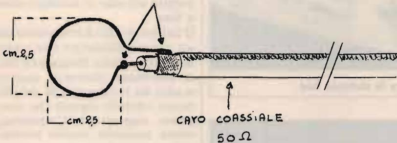
Sonda da collegare al frequenzimetro.
