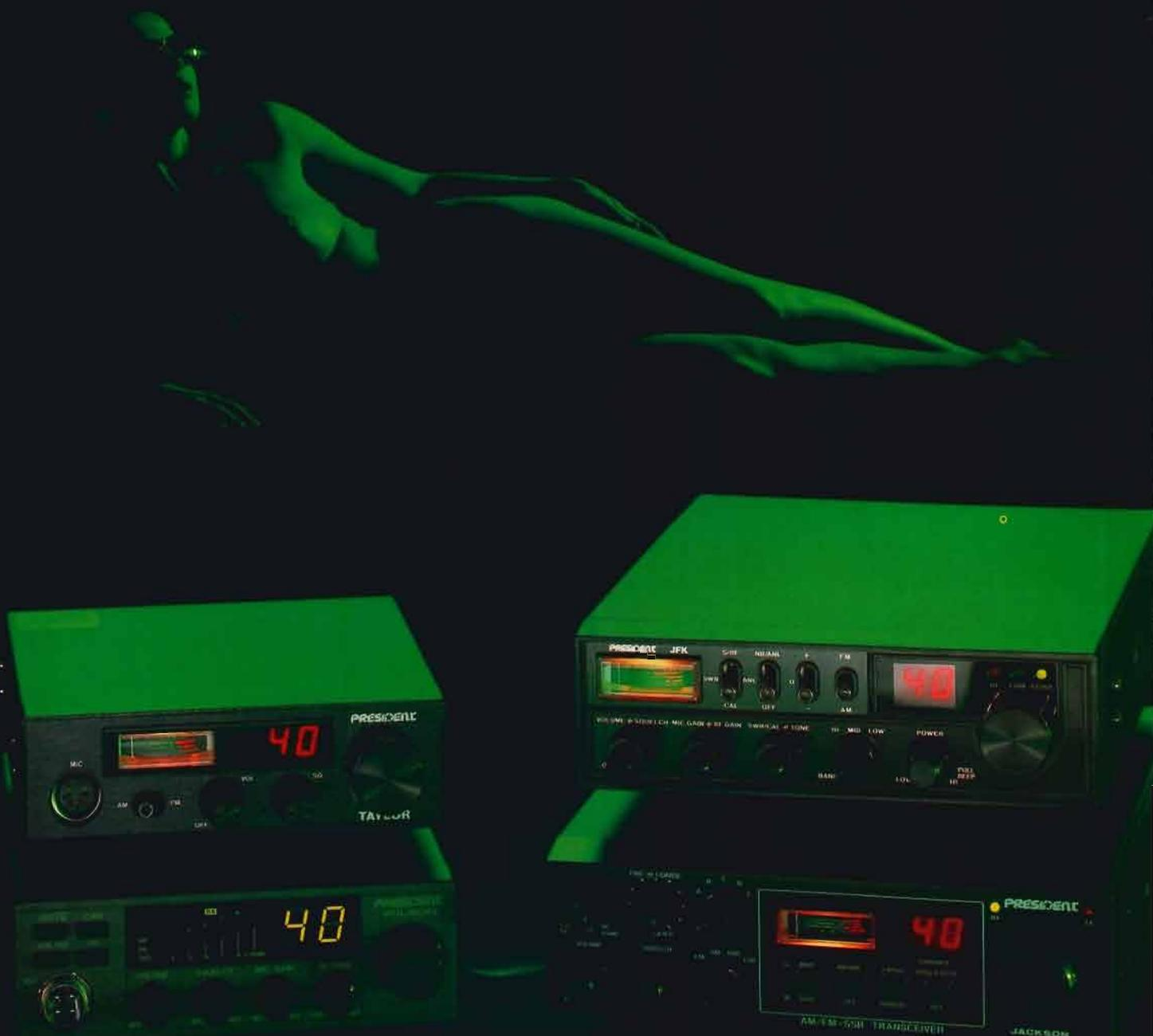
**TAYLOR** - CARATTERISTICHE TECNICHE: 40 canali in AM-FM • Potenza d'uscita: 4 W • Sensibilità: AM 0.5 mV (10 dB S/D), FM 1 mV (20 dB S/D) - CONTROLLI E FUNZIONI: Selettore canali • Volume con interruttore d'alimentazione • Squelch • Indicatore di canale • Visualizzazione a strumento di intensità di campo e di potenza • Controllo automatico per la soppressione dei disturbi • Omologato.
