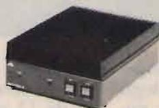
Frequenza di lavoro: 2 ÷ 30 MHz • Modi di impiego: FM AM-SSB-CW • Ros. di ingresso: 1,2-1 • Ros. di uscita: 1,1-1 • Impedenza di ingresso: 50 Ohm • Impedenza di uscita: 50 Ohm
