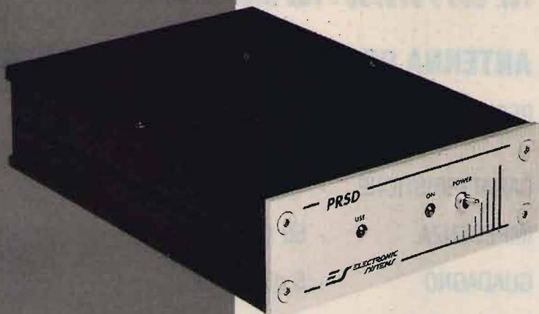
Permette di trasformare un apparecchio ricetrasmittente Simplex in un Ponte Ripetitore. Riceve la comunicazione dall'RTX a cui è collegato, la memorizza e ritrasmette la comunicazione stessa. Ottima qualità di riproduzione. Possibilità di apertura automatica con Vox o con SQUELCH.
