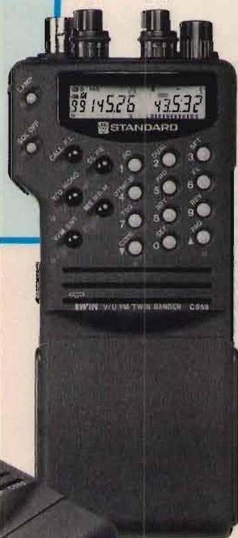
Costruito secondo le norme europee è dotato anche del tono a 1.750 Hz.
