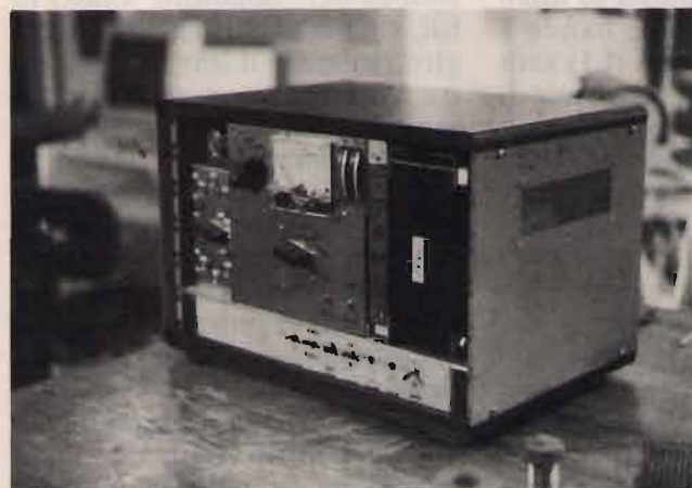
②④ "Si inizia ad assemblare il lineare (a taratura avvenuta) nel mobile destinato a contenerlo". Vista frontale.
