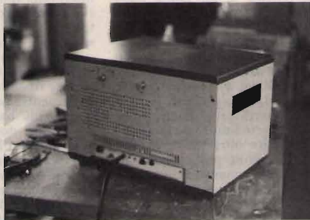
②⑦ "Vista del pannello posteriore. I fori consentono un'adeguata ventilazione forzata".
